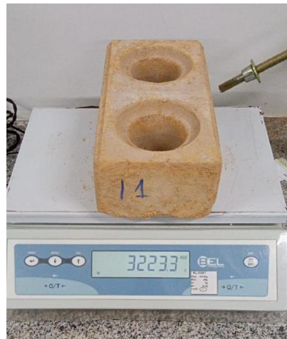
Figura 7. Exemplo de Obtenção da Massa do Corpo de Prova Seco.
