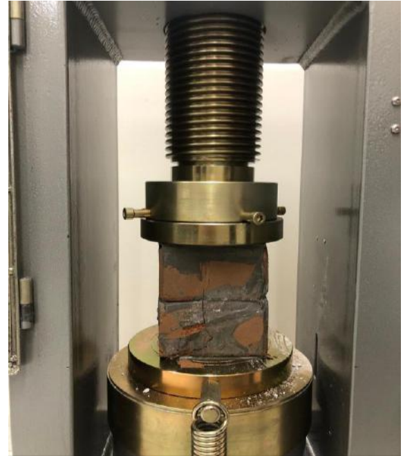
Figura 5. Ruptura de Corpo de Prova.
