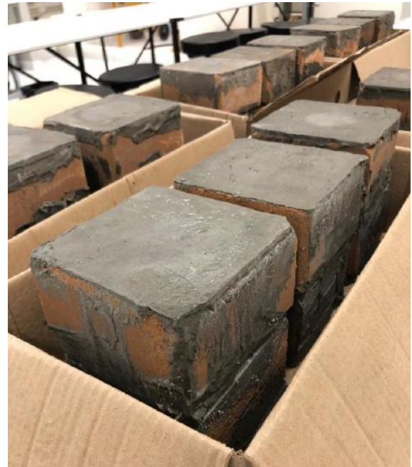
Figura 2. Sobreposição das Duas Metades de Alguns Corpos de Prova. Figura 3. Corpos de Prova com Faces de Trabalho Capeadas.
