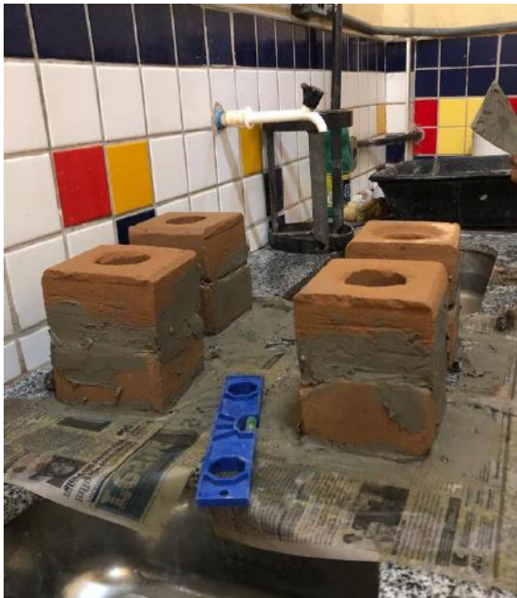
Figura 2. Sobreposição das Duas Metades de Alguns Corpos de Prova. Figura 3. Corpos de Prova com Faces de Trabalho Capeadas.
