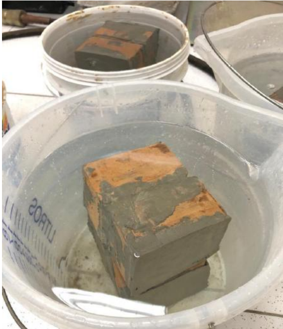
Figura 4. Imersão de Corpos de Prova em Água.
