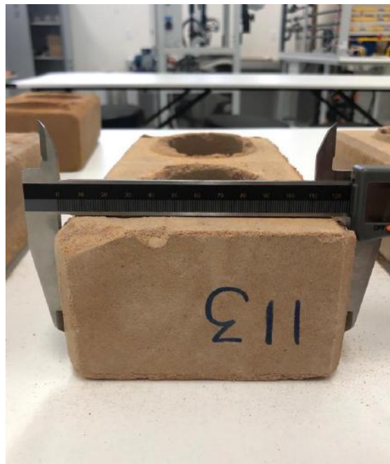
Figura 1. Dimensionamento de Corpo de Prova.
