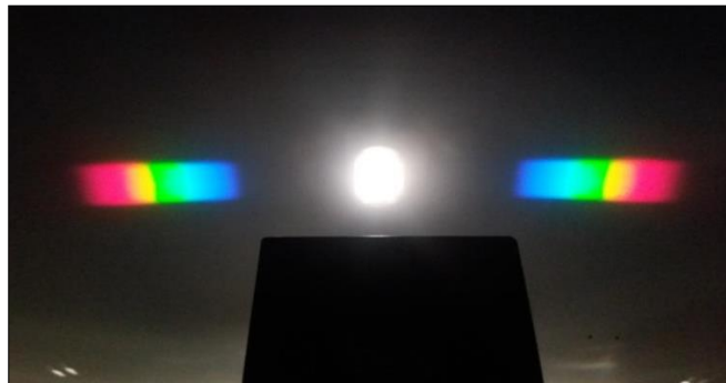
Figura 2. Difração da luz branca ao passar pela grade e ser projetada no anteparo.
