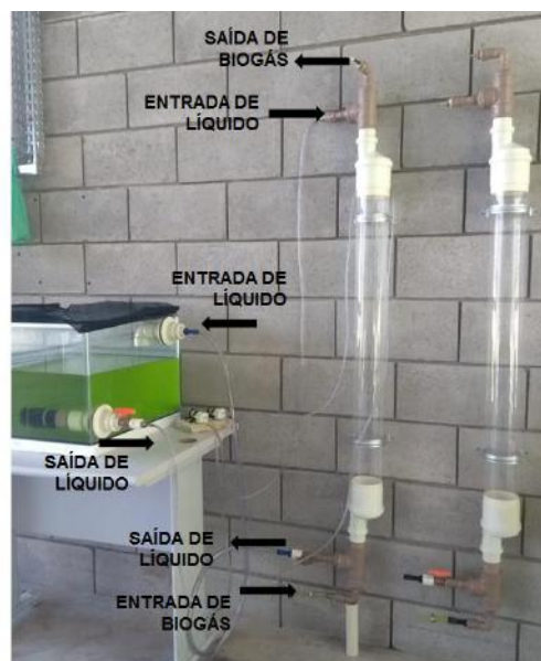
Figura 4. Fluxo do líquido e do biogás.
