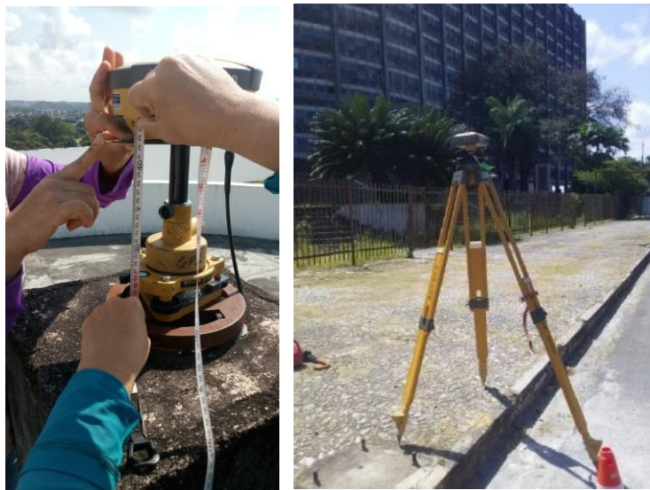
Figuras 5b e 5c. (b) Ocupação GNSS da estação de referência SAT GPS 91551 e do ponto de apoio ponto P5 (c).
