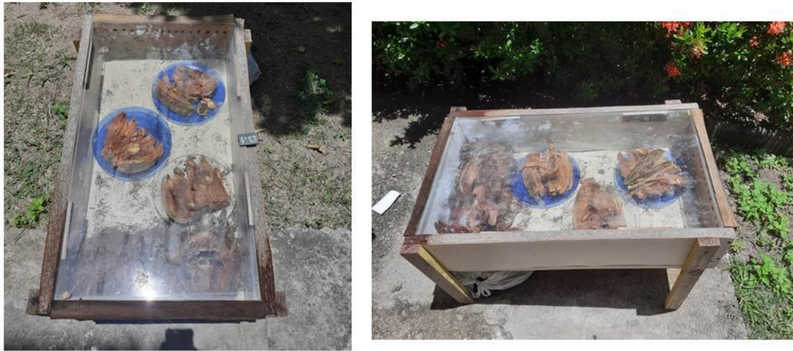
Figura 3: Secador solar com cascas de coco em dois ângulos.
