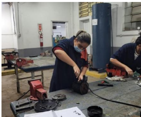
Figura 5 - Alunas do treinamento desmontando o redutor.
