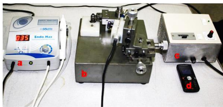
Figura 3 – (a) Motor elétrico utilizado para o acionamento dos instrumentos; (b) dispositivo utilizado para o ensaio dinâmico; (c) fonte de alimentação que contém os dispositivos de regulação de rotação e o contador de pulso; (d) cronômetro digital.
