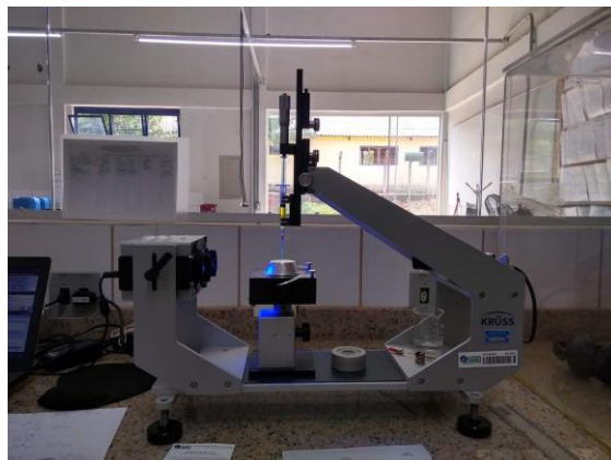
Figura 5 - Equipamento para a medida do ângulo de contato utilizado na UFLA. Já com a seringa e o anteparo metálico utilizados.
