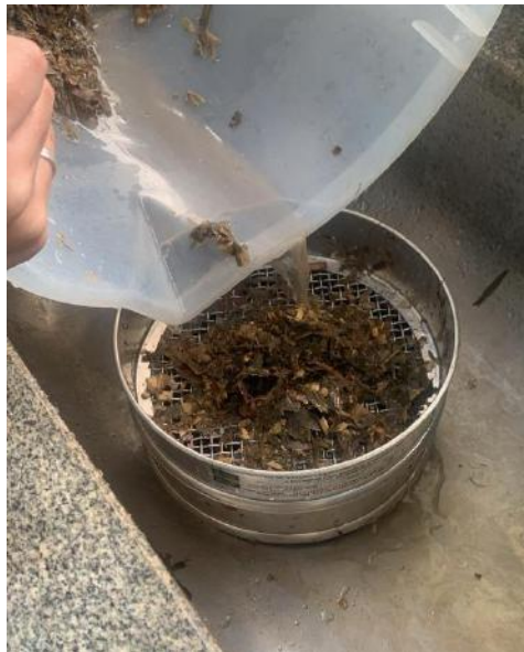
Figura 3 - Separação de grãos inteiros e grãos quebrados com auxílio de uma peneira de malha 4,75 mm.
