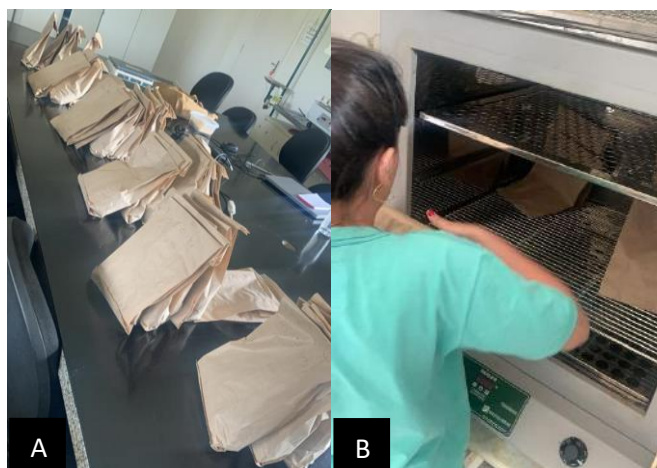
Figura 4 - Amostras de silagem peneiradas em Penn State (A) e levadas a estufa para secagem a 62°C por 72h (B).
