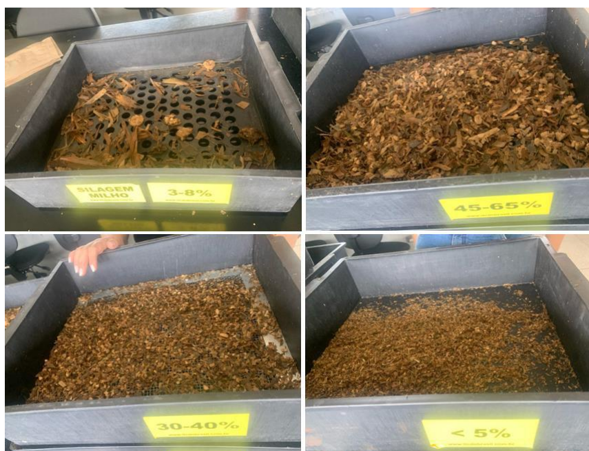
Figura 3 - Amostra de 500g de silagem de milho após agitação para separação por gravidade em peneira Penn State.
