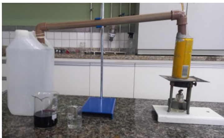
Figura 4 - Experimento destilador produzido com materiais alternativos.
