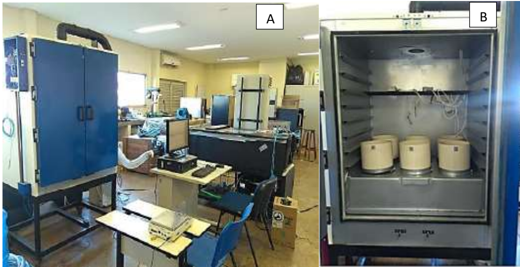
Figura 1 - Sistema de secagem com bomba de calor (A), câmara de secagem e peneiras (B).
