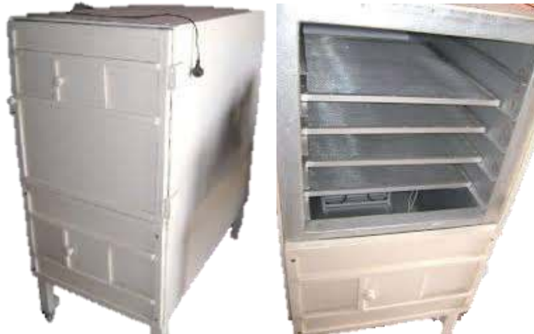
Figura 2 - Secador elétrico de leito fixo.
