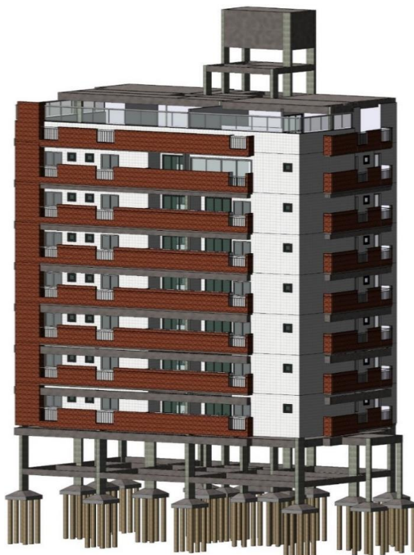
Figura 13 - Elevação do projeto com o sistema de fundação completo (sapatas e estacas de compactação).
