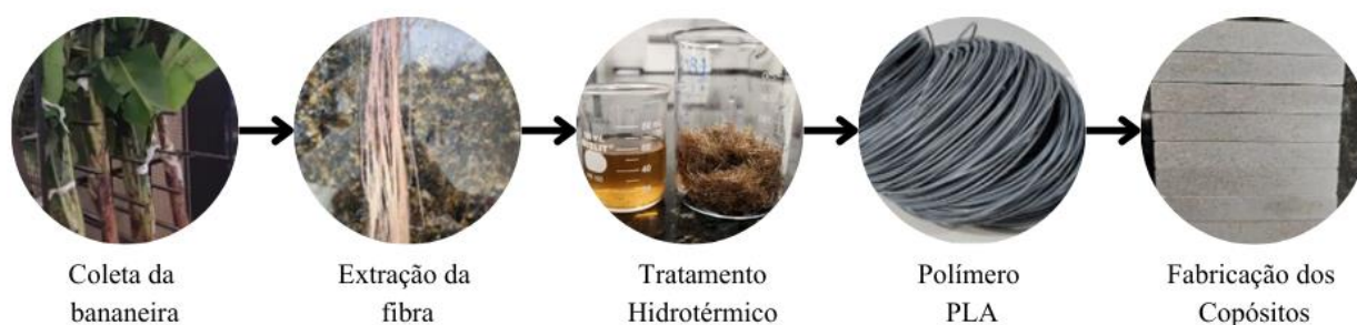
Figura 1. Fluxograma da metodologia de fabricação dos biocompósitos.
