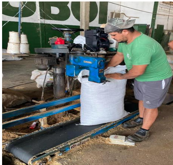
Figura 15 - Operação de costurar os sacos de rafia por meio de uma máquina de costura mecânica da Empresa Duboi em Sousa-PB.
