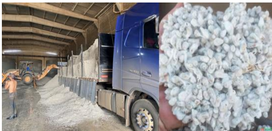
Figura 4 - Descarregamento de caroços de algodão da carroceria da carreta por meio de uma máquina retroescavadeira no galpão da empresa Raça Forte da cidade de Patos, PB.
