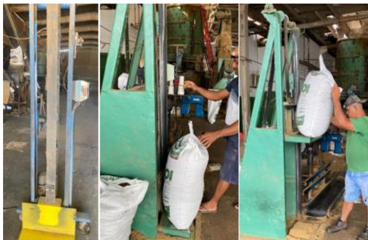
Figura 16 - Elevador de sacos de torta para auxiliar o operário no seu trabalho de transporte manual durante a operação de empilhamento dos sacos de torta de algodão.
