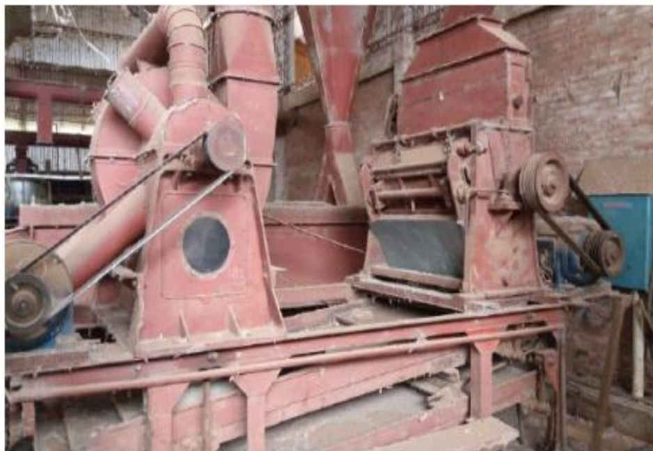
Figura 22 - Descascador usado para obtenção de amêndoas pela eliminação da casca ou tegumento de sementes de algodão da usina algodoeira Godefroy em Santa Cruz de la Sierra, Bolívia.
