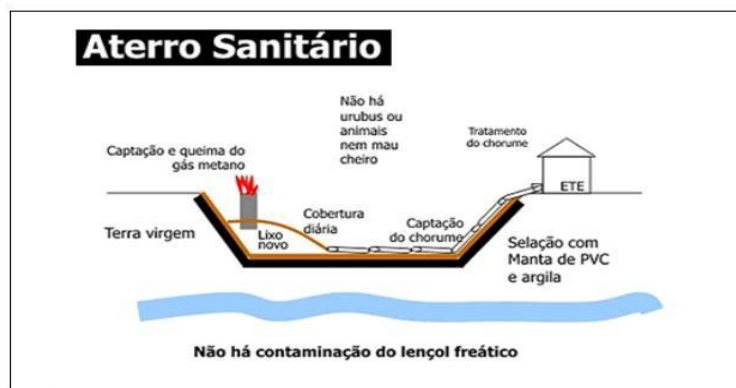
Figura 4 - Esquema simplificado de um aterro sanitário.
